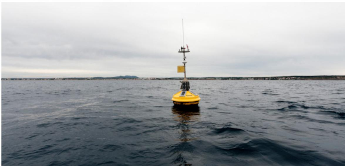
**Figura 1.** Imagen de la boya de Palma del SOCIB utilizada para medir variables oceanográficas como la salinidad. FUENTE: SOCIB.
