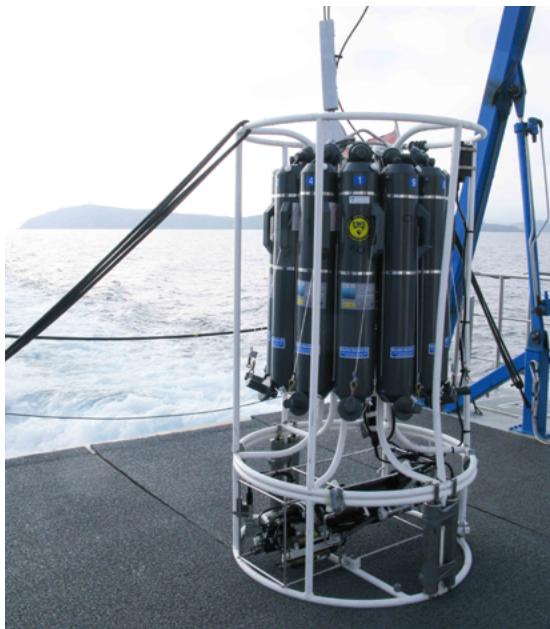
Figura 1. Dispositiu CTD utilitzat en campanyes oceanogràfiques per mesurar paràmetres de temperatura, salinitat i profunditat, entre d'altres variables. FONT: Miquel Gomila.
